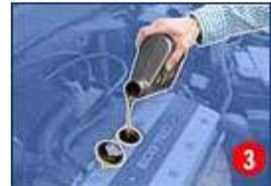
**Motor Yağ Seviyesinin Kontrol Edilmesi:** Araç 15-20 dk çalıştırıldıkten sonra düz bir zemine park edilerek motor stop edilir. **4-5 dakika bekledikten sonra** yağ çubuğu çekip temizler ve tekrar yerine takarız sonra tekrar çekip yağ seviyesini kontrol ederiz. **Yağ seviyesi, çubukta belirtilen iki çizgi arasında ise motor yağıının yeterli anlaşılr.**
