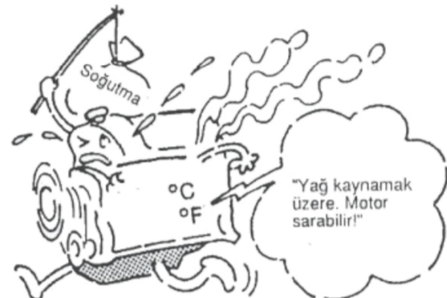
**Hararet yapmış olan araç 10-15 dk. Rolantide çalıştırıldıktan sonra radyatör kapağı soğuk ve ıslak bir bezle önce gevşetilir hava basıncı alınır, daha sonra açılarak ılık su ilave edilir. Soğuk su ilave edilirse motor bloğu ve silindir kapağı çatlayabilir.**
