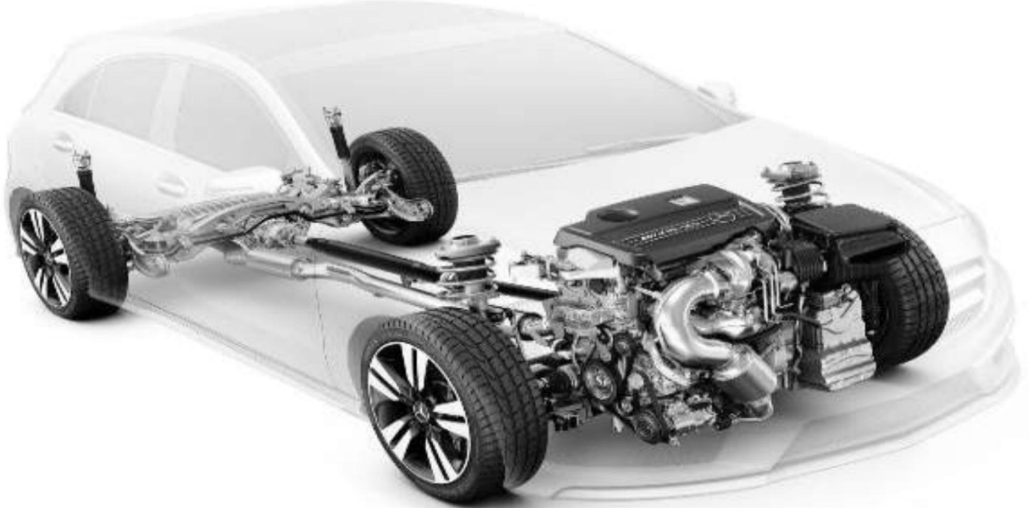
Ateşleme Sistemi, Yakıt Sistemi, Yağlama Sistemi, Soğutma Sistemi, Şarj Sistemi, Marş Sistemi, Egsoz Sistemi, Elektrik - Aydınlatma ve ikaz sistemi, Göstergeler Sistemi, Fren Sistemi, Ön Düzen Sistemi, Süspansiyon Sistemi
